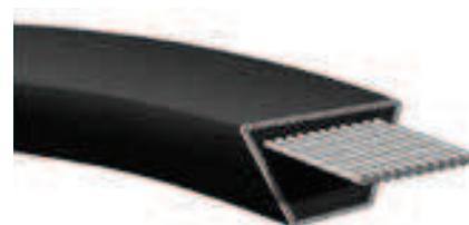
N.º de Parte: B75 B Ancho superior 0.66" - Perfil clásico 75 Aproximadamente 75" longitud interna
