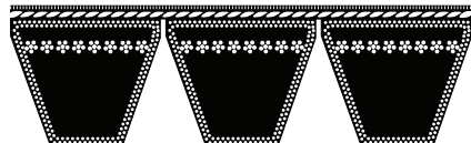
Sección transversal con forro 5V, 8V
