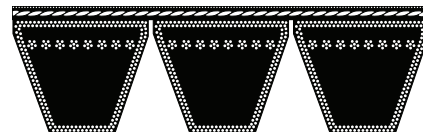
Vista de la sección transversal 5VF y 8VF
