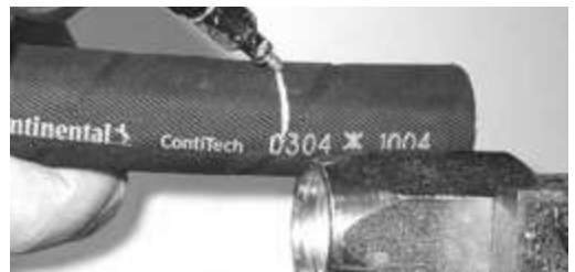
Marcar profundidad de inserción.
