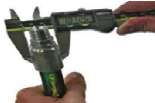
Verificar diámetro de crimpado con calibrador.
