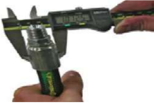
Verificar diámetro de crimpado con calibrador.
