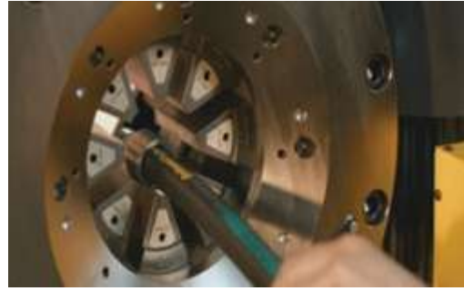
Insertar el ensamble de manguera dentro del dado.
