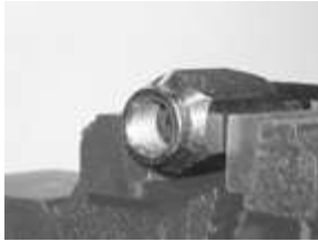
Chequeo visual de la posición de manguera dentro del socket.
