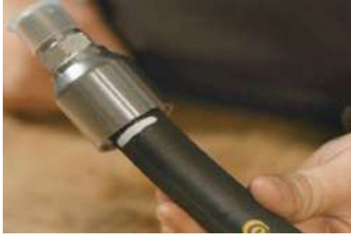
Insertar la conexión en la manguera.
