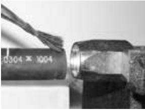
Aplicar lubricante a la cubierta de manguera.
