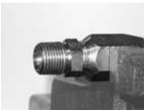
Espiga bien asentada contra el socket.
