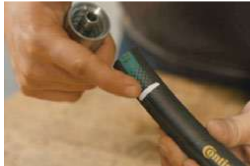
Marca de profundidad de inserción.
