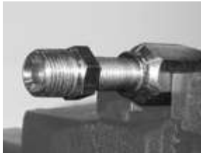
Atornillar la espiga dentro del socket.
