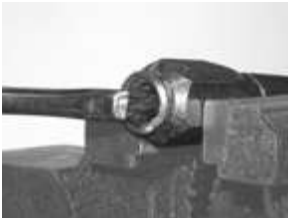
Aplicar lubricante a la espiga y el tubo de la manguera.
