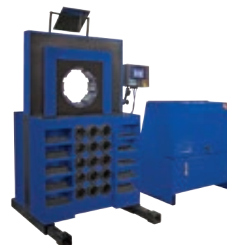
CC1000 Máquina Crimpadora hasta 10"
